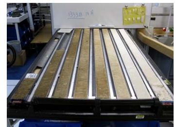
Bohrkern 1333B im Sedimentlabor auf dem Forschungsschiff Joides Resolution. Zu sehen ist der Übergang von braunen (links) zu weißen Sedimenten (rechts), die den Bereich der permanenten antarktischen Vereisung vor 34 Millionen Jahren (Eozän/Oligozän-Grenze) markieren (Copyright: Jens Herrle, Goethe Universität Frankfurt).
