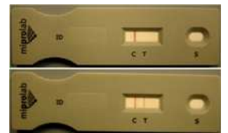
miprolab-Schnelltest mit Testkassette: oben negativ (es erscheint nur die Kontroll-Linie, die anzeigt, dass der Test funktioniert hat), unten positiv (es erscheinen Kontroll-Linie und Test-Linie). http://www.bik-f.de/images/aktuelles/photos_presemeldungen/miprolab-schnelltest_300dpi.jpg
