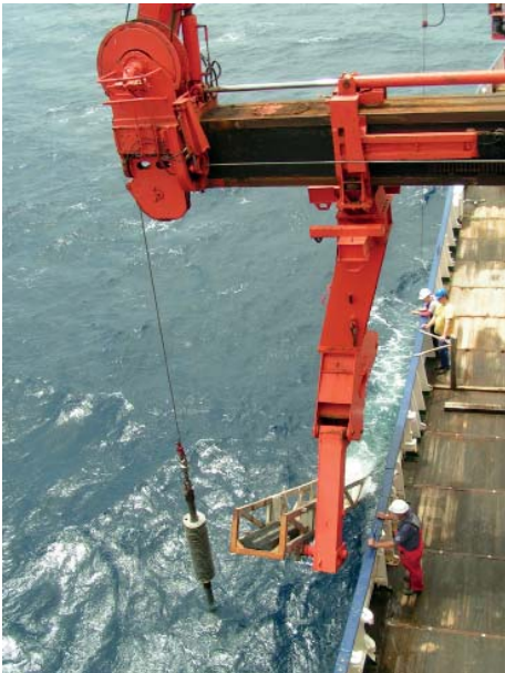
Entnahme eines Sedimentbohrkerns © E. Niedermeyer
